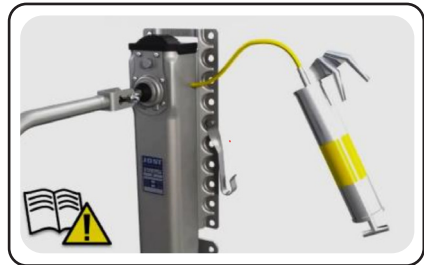
مرحله دوم: استفاده از سیلندر مخصوص جهت روغن کاری (تقریباً ۲۰۰ گرم)
